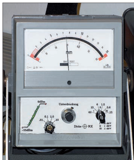
Bild 7: Das analoge Messinstrument zeigt das Maximum des Mondrauschens.
