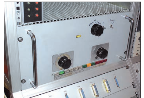
Bild 4: Manuelles Steuergerät für den 10-m-Spiegel
