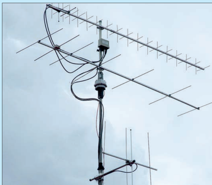
Bild 1: Leistungsfähige Antennenanlage mit 70-cm-Kreuzyagi an einem Glasfaserrohr, darunter horizontal polarisierte Yagi-Antenne für 2 m; das Glasfaserrohr dient zugleich als Drehrohr des Rotors. Unterhalb desselben befindet sich an einem Ausleger eine vertikal polarisierte 2-m-Yagi für Orts-QSOs in FM.
