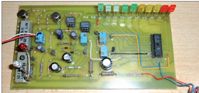
Bild 1: Ansicht des Musters der Interface-Leiterplatte mit Balkenanzeige und VOX; die NF-Übertrager und Potenziometer sind separat auf einer Universal-leiterplatte untergebracht.
