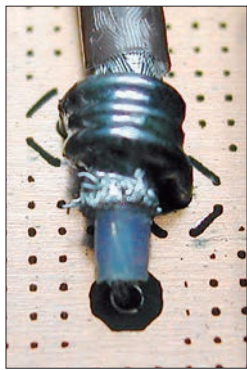
Bild 5: Befestigung des Koaxialkabels auf der Leiterplatte
