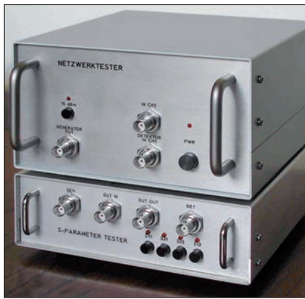
Bild 7: Der S-Parameter-Messzusatz (unten) erhielt ein eigenes Gehäuse, das mechanisch und optisch zu dem des Netzwerktesters passt.
