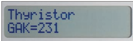
Bild 5: Erkennt der Bauteiltester einen Thyristor, zeigt er die Anschlussbelegung an.
