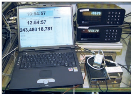
Bild 3: Antennen-Positionsgeber, SD-Empfänger und Laptop mit Steuerprogramm
