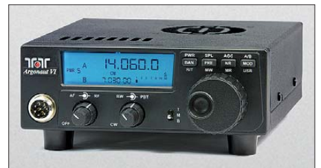
Mit dem kompakten Argonaut VI bietet Ten-Tec einen vollwertigen KW-Transceiver für jene, die das Funken mit kleiner Sendeleistung als sportliche Herausforderung ansehen.
