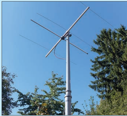
Bild 6: Ein aus zwei HT-Rohren DN50 und DN40 zusammengesetzter Mast ermöglicht SWV-Messungen an Antennen; für den Funkbetrieb erbringt er jedoch zu wenig Höhe.
